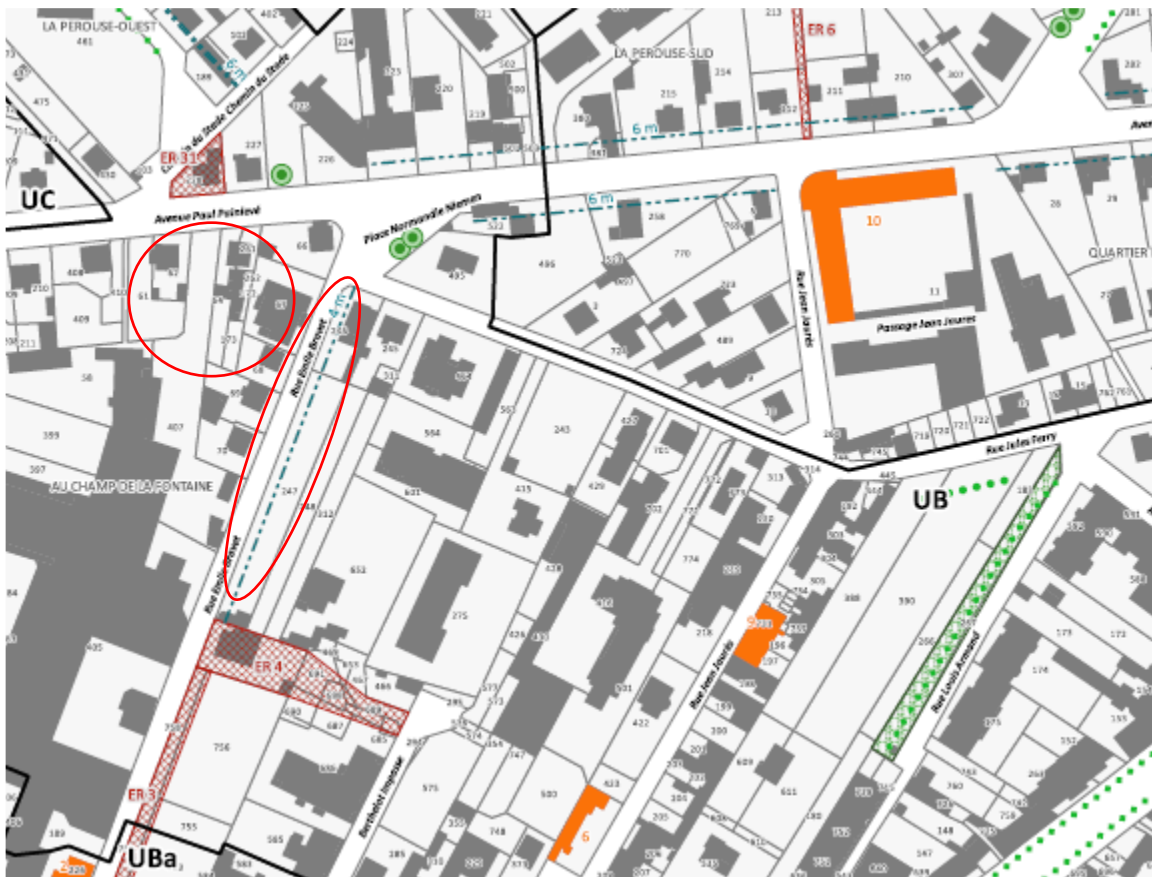
Suppression ER 31 partie Sud et implantation du bâti dans une marge de recul de 4 m par rapport à la limite parcellaire.
