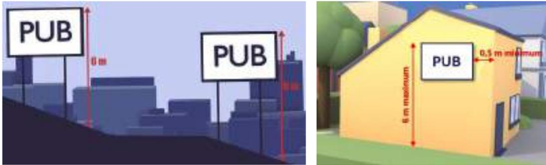
*Schématisation de la règle de hauteur pour les dispositifs scellés au sol ou installés directement sur le sol et pour les dispositifs muraux (schéma indicatif et non opposable)*
